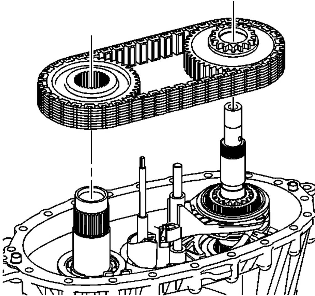
**Fig. 132: Drive Chain & Sprockets**
