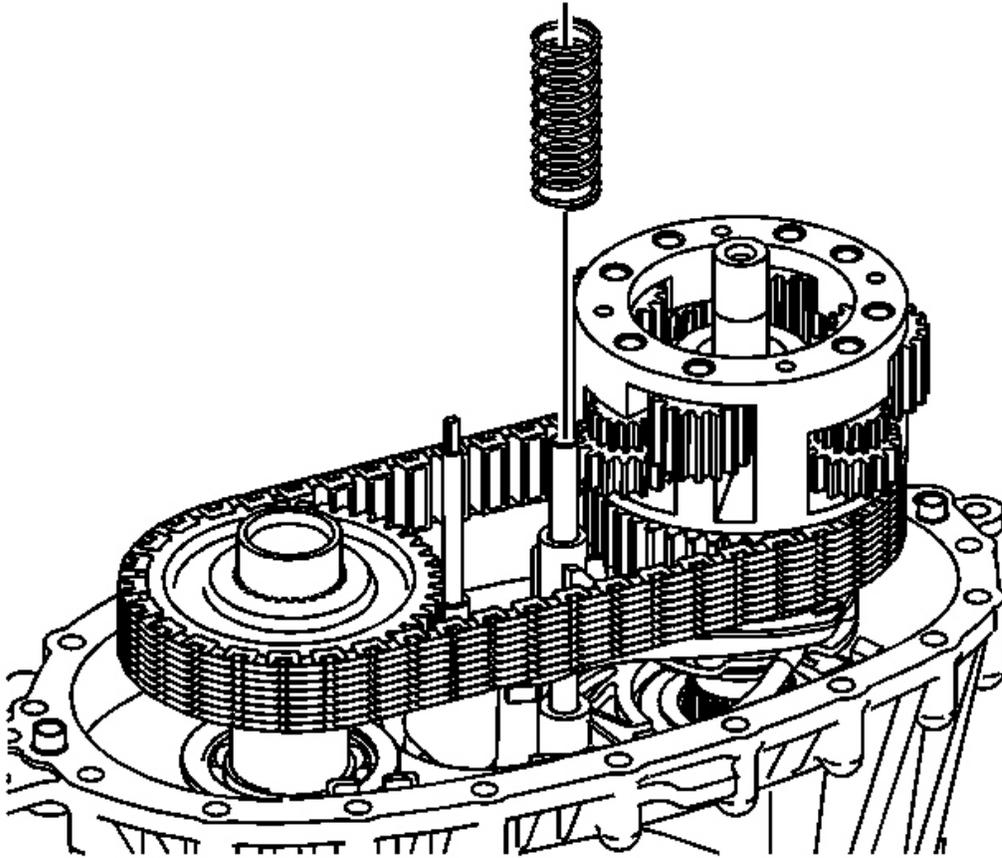
**Fig. 139: Shift Fork Shaft Spring**
