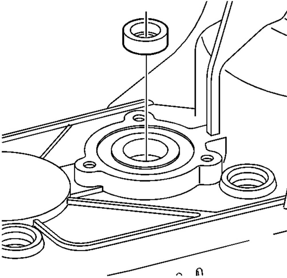
**Fig. 107: Seal For Shift Detent Lever Shaft**
