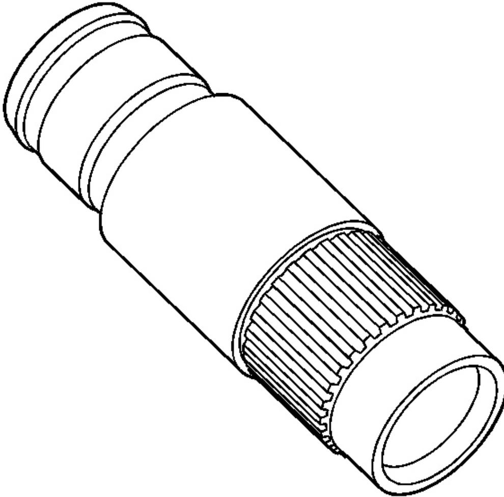
**Fig. 64: Front Output Shaft**
