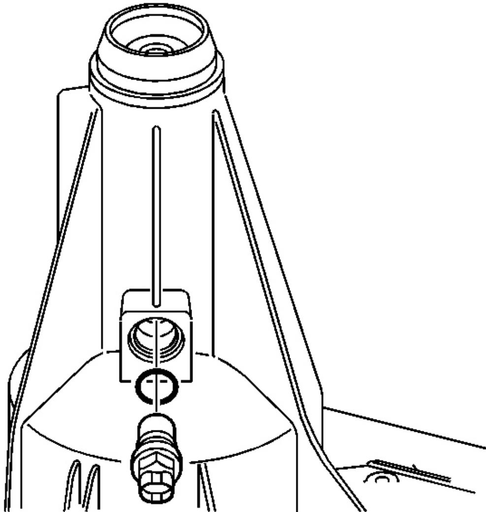
**Fig. 45: Speed Sensor & O-Ring**
