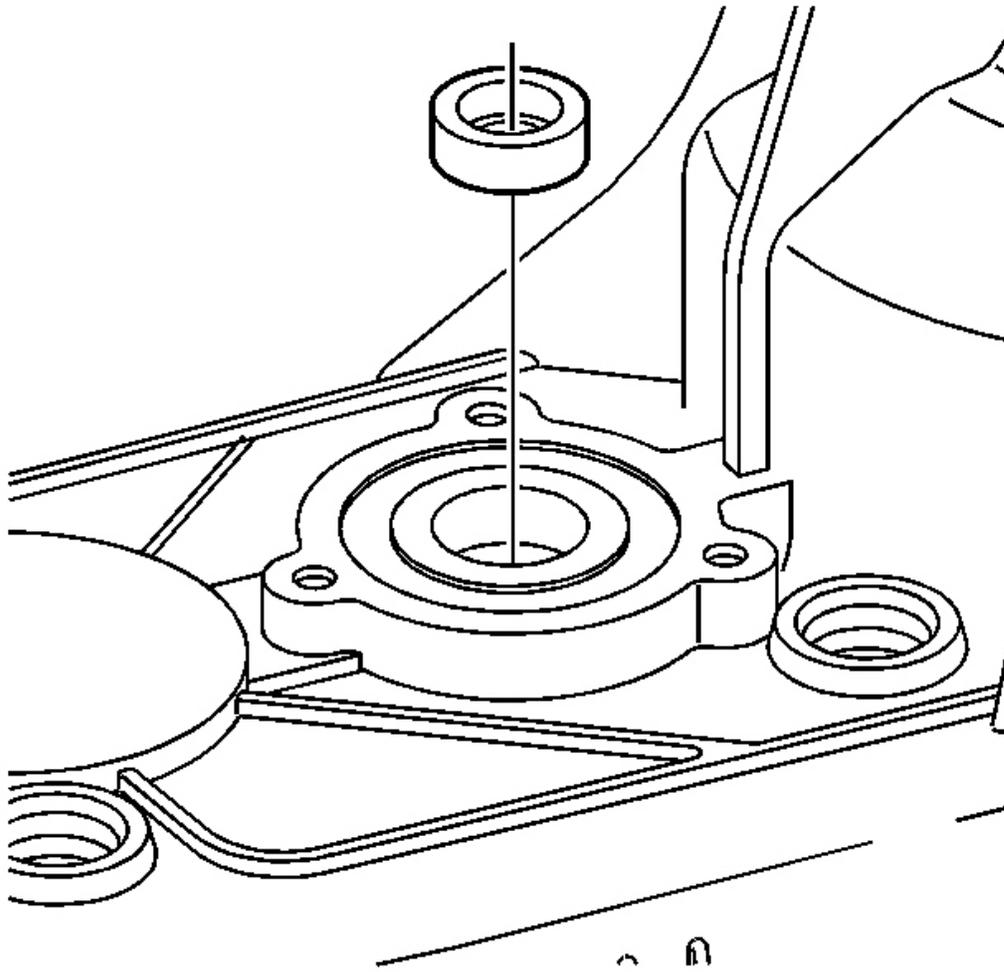
**Fig. 87: Seal For Shift Detent Lever Shaft**
