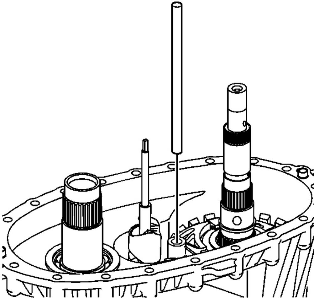
**Fig. 88: View Of Shift Fork Shaft**
