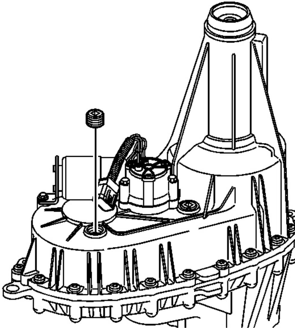
**Fig. 152: Drain Plug & Fill Plug**
