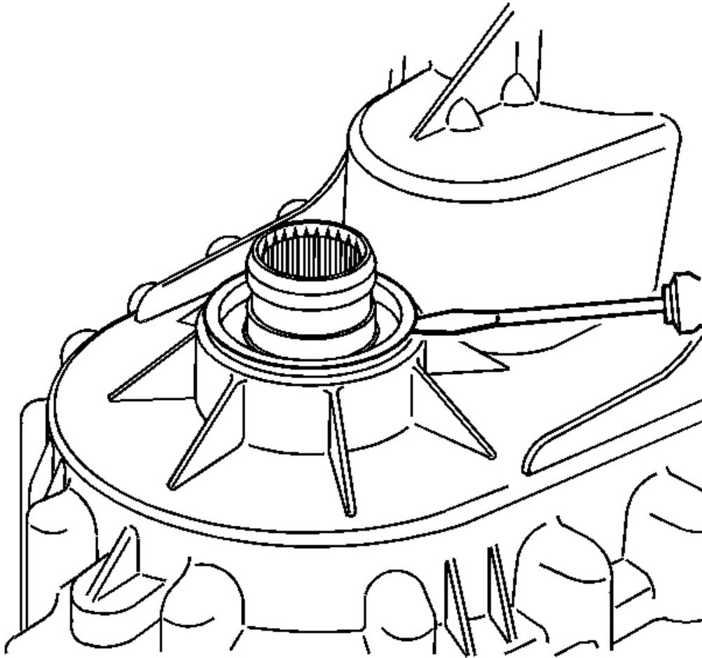
**Fig. 43: Output Shaft Seal**
